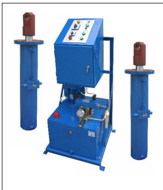
Tandem aktuator 90-0210 koristi se za sinhrono spuštanje ili podizanje tereta na određenu visinu i njegovo osiguranje u zadatom položaju. Brzina kretanja cilindra je konstantna i podešava se u skladu sa pritiskom u sistemu i teretom koji deluje na istu.
